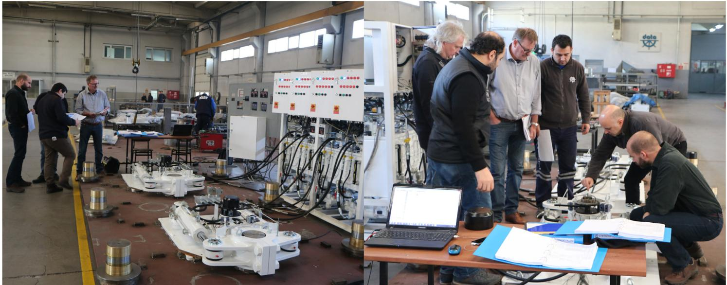
Hollanda temsilcimiz Promac firmasının mühendislerini firmamızda ağırlayarak 1 günlük eğitim verdik. Fabrika testleri için hazırlanmış ve tüm fonksiyonları ile çalışır durumda elektronik senkronizasyonlu bir dümen sistemi üzerinde mekanik, hidrolik ve elektrik ana başlıklarını altında dümen sistemini tanıtarak devreye alma ve servisi konusunda eğitim verdik.
